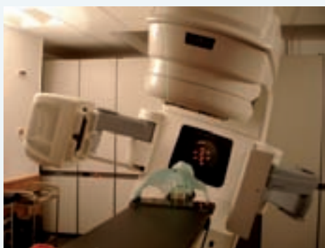
Figure 1. Accélérateur linéaire de dernière génération équipé d'un système d'imagerie embarquée Varian On-Board Imager™ (service de radiothérapie, hôpital européen Georges-Pompidou, Paris).
